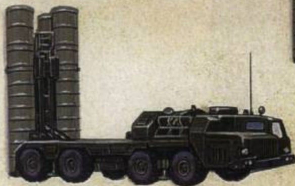
Пусковая установка (дополнительная) 5П85ДУ с 4 ракетами (до 8) 5P85DU additional launcher (up to 8)
